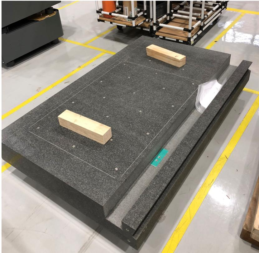
Figura 4.3: Basamento in granito della Global
