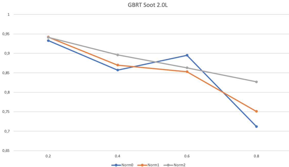
Figura 6.22. Andamento delle tre normalizzazioni in funzione del  $r^2$  e dei 4  $TTs$  per il motore 2.0L nel caso dell’inquinante *soot*
