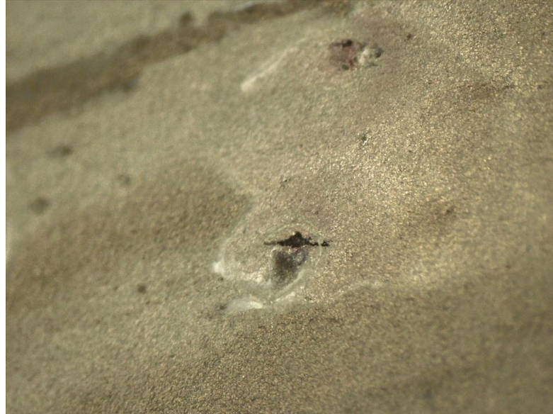
Figura 2, Punto di corrosione per vaiolatura
