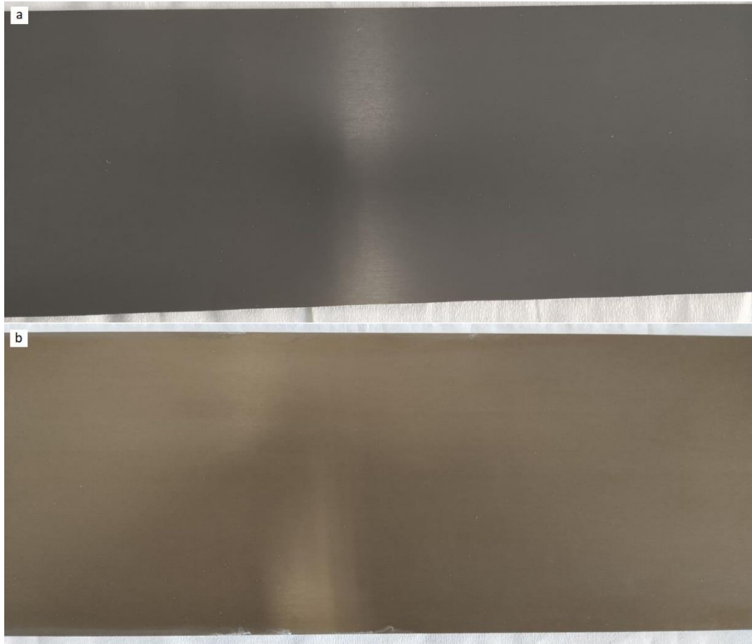
Figura 25, a) Provino di riscontro; b) Provino trattato in nebbia salina
