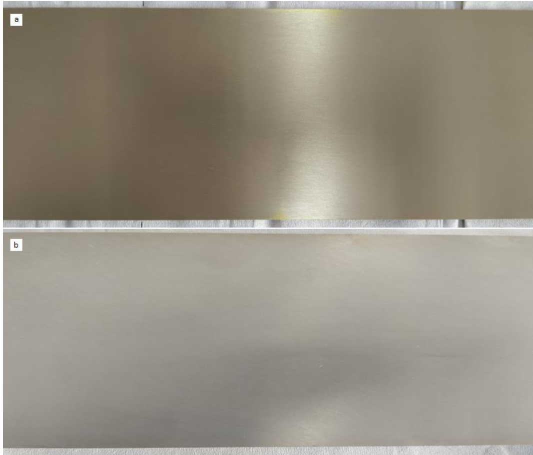
Figura 5, a) Provino di riscontro; b) Provino trattato in nebbia salina
