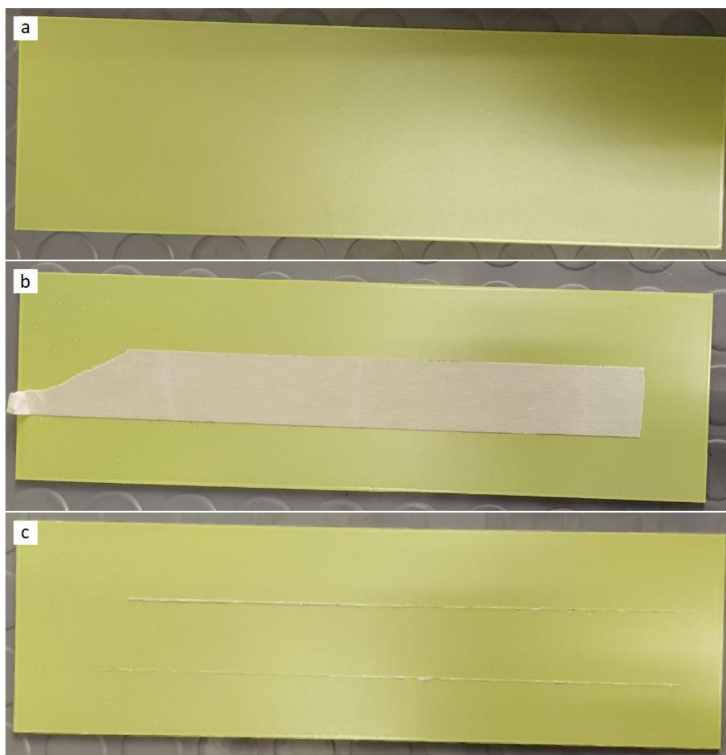
Figura 17, Prova di adesione ad umido su un provino standard
