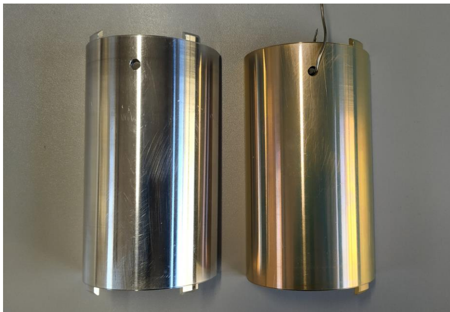
Figura 6, Sezioni del "dumper", a sinistra il componente pulito con MEK, a destra il componente trattato con conversione cromica
