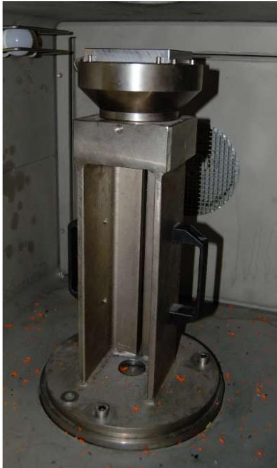
Figura 5.2. Sistema di afferraggio del provino nel macchinario CEAST 9350
