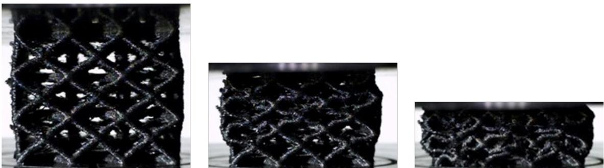
Figura 3.11. Sequenza di rottura provino E\_01\_07\_01
