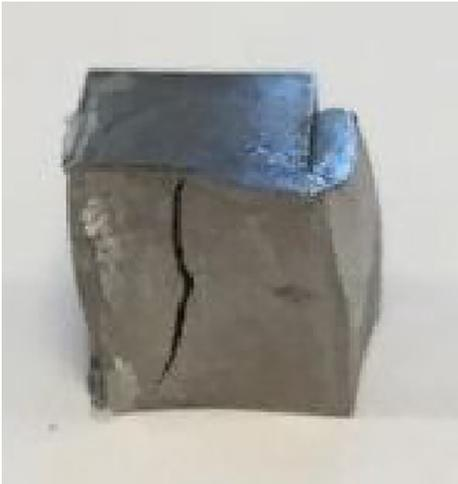
Figura 2.4. Rottura provino classico sottoposto a compressione [7]
