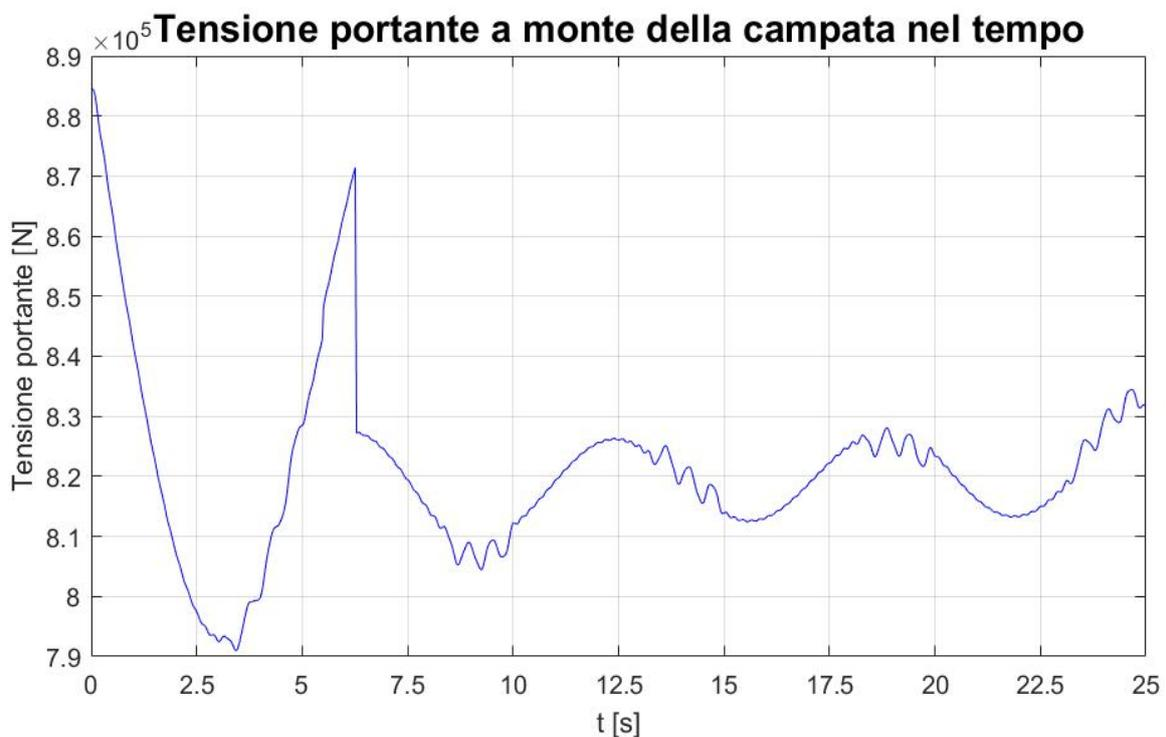
Figura 3-53: Tensione della portante a monte della campata
