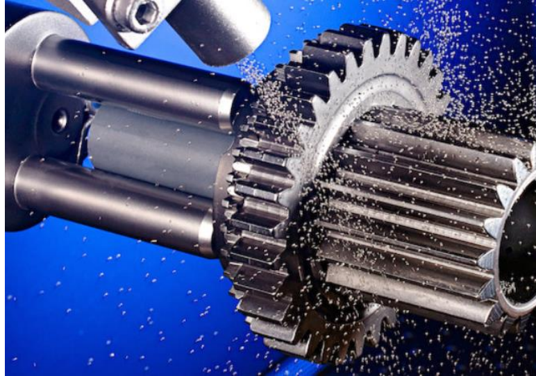
Figura 27 Processo di pallinatura
