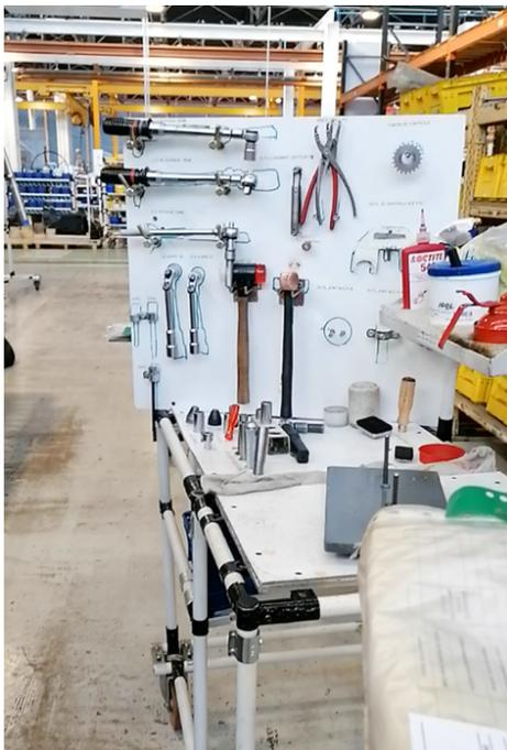
*Figura 32 Dettaglio piano di lavoro e superficie porta attrezzi OP200*
