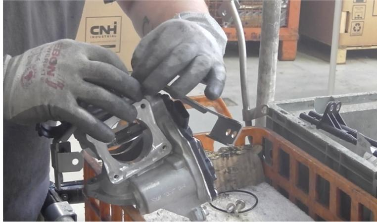
*Figura 35 OP190/2 errato utilizzo del carrello kit per il montaggio del sottogruppo valvola EGR.*
