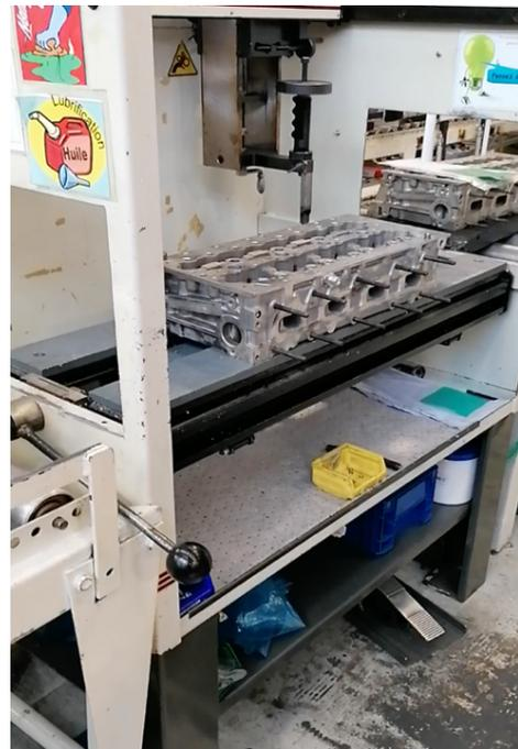
*Figura 33 Dettaglio pressa per testata OP200*
