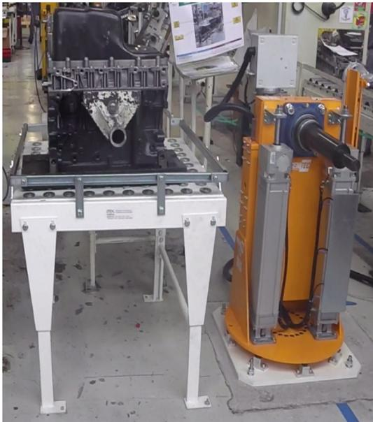
*Figura 27 Dettaglio piano a sfere e ribaltatore motore OP150*
