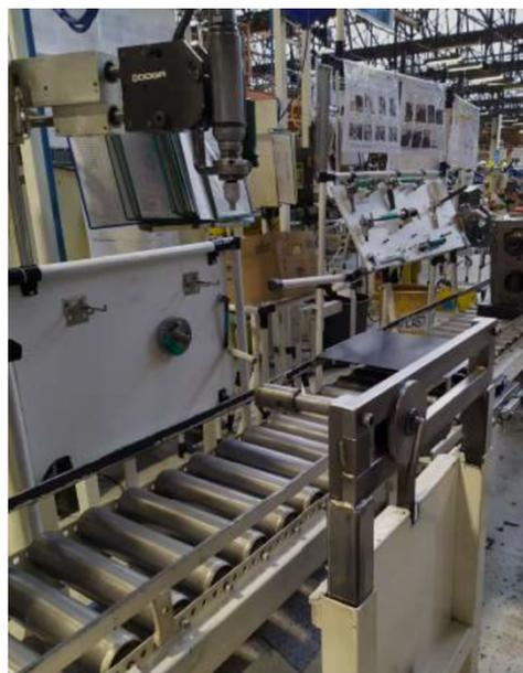
*Figura 20 Dettaglio avvitatore a colonna monomandrino OP130*
