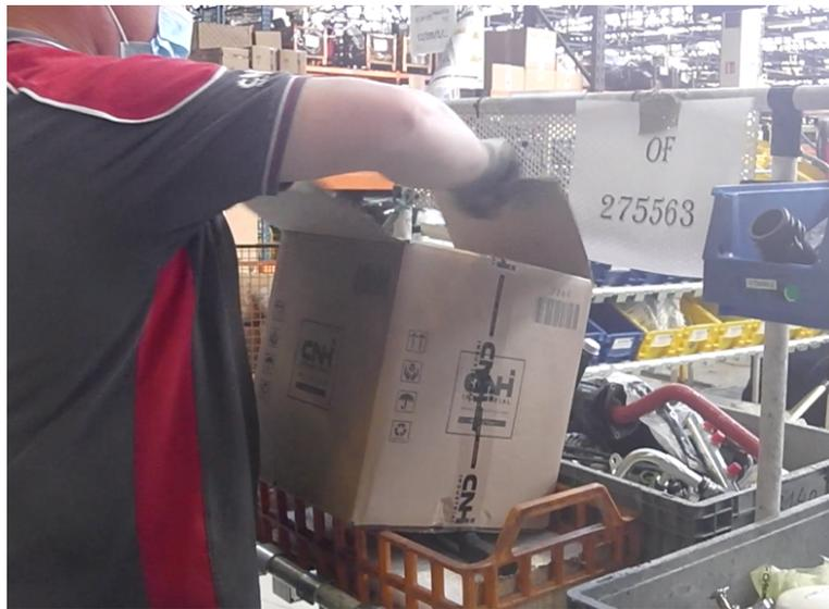
*Figura 36 OP 190/2 Errato utilizzo del carrello kit per eseguire uno sconfezionamento*
