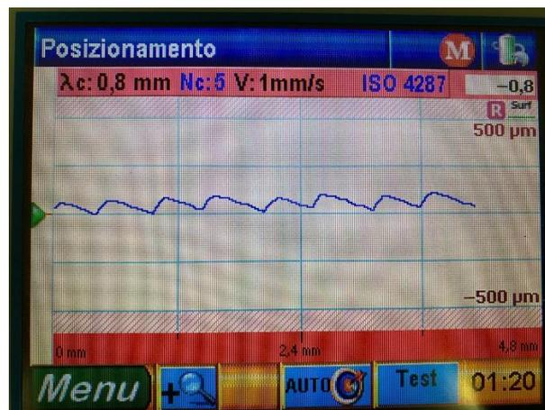
*Figura 44 - Effetto staircase visto al rugosimetro*
