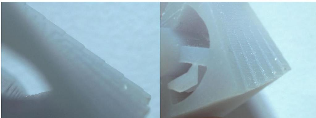
*Figura 34 - Ingrandimento dei campioni per la visualizzazione dell'effetto staircase su campioni a spessore 0,1 mm*
