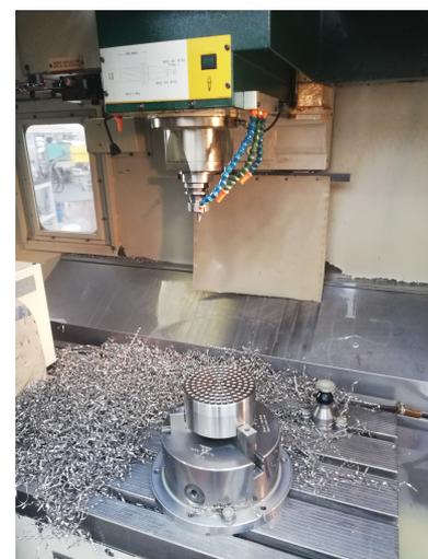
Figura 13 – Centro di lavoro Bridgeport 800 XP utilizzato per le prove (il portellone di sicurezza è aperto per mostrare l'interno dove si può notare un blocco di acciaio 16MnCr5); a destra particolare della zona di lavoro. La presenza dei trucioli è dovuta all'operazione di foratura per realizzare i prefori da maschiare.
