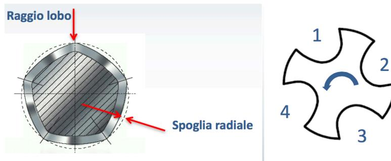
Figura 3 - A sinistra sezione trasversale del tratto filettato di un maschio a rullare; a destra sezione trasversale del tratto filettato di un maschio ad asportazione
