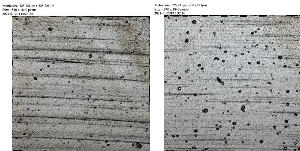
Figura 33 - A sinistra maschio MF07 ( $S_a = 150 \mu\text{m}$ ) mentre a destra maschio MF07 modifica ( $S_a = 108 \mu\text{m}$ ); il colore grigio è legato al rivestimento AlCrN presente su entrambi i maschi
