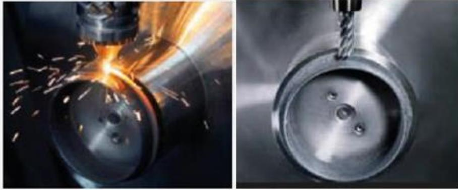
*Figura 75: Deposizione e fresatura in un sistema ibrido*
