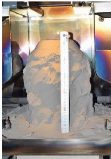
*Figura 51: Componente inglobato nel blocco di polvere alla fine della fase di raffreddamento*
