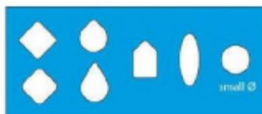
Figura 55: Strutture auto-supportanti [6]
