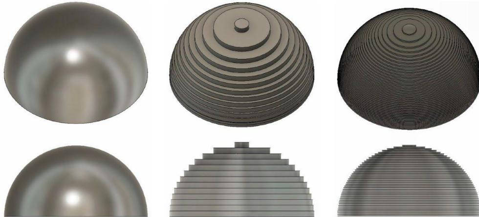
Figura 35: Effetto scala in funzione del  $\Delta s$
