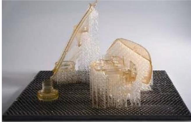
*Figura 20: Green-part sulla piattaforma di costruzione*
