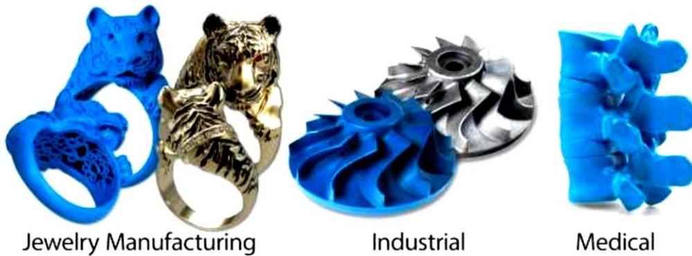
*Figura 24: Componenti costruiti mediante Drop on Demand*
