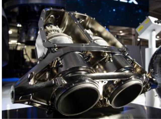
*Figura 67: Endoreattore SuperDraco totalmente stampato in 3D. Credit Space X*
