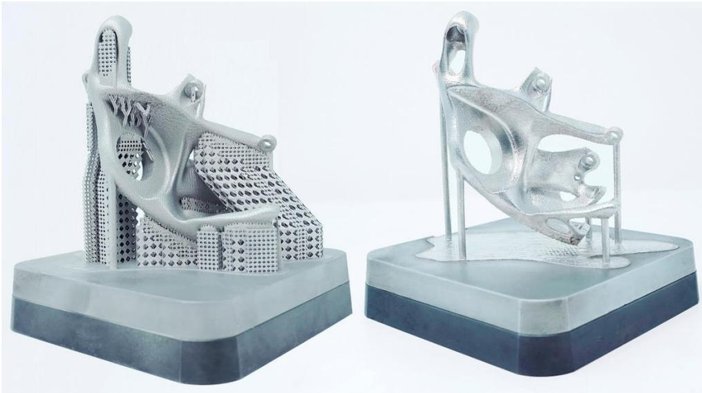
Figura 33: Componente metallico con supporti (sinistra) e senza (destra).
