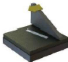
Figura 63: Soluzione ad una sottile sezione parallela al recoater [6]
