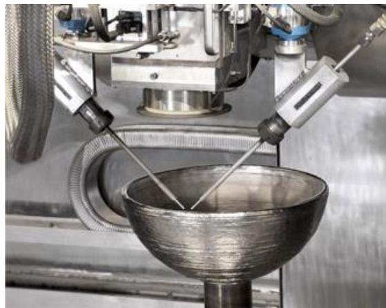
*Figura 65: Processo EBAM per la costruzione della cupola di un serbatoio [7]*
