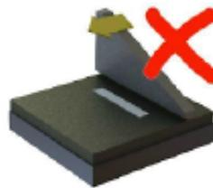
Figura 62: Sezione sottile parallela al recoater [6]
