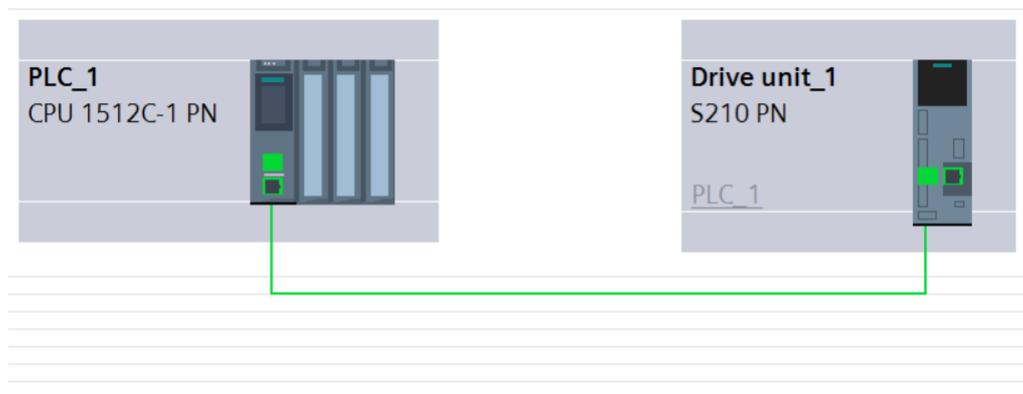
Figura 46: Collegamento topologico tra Drive e PLC
