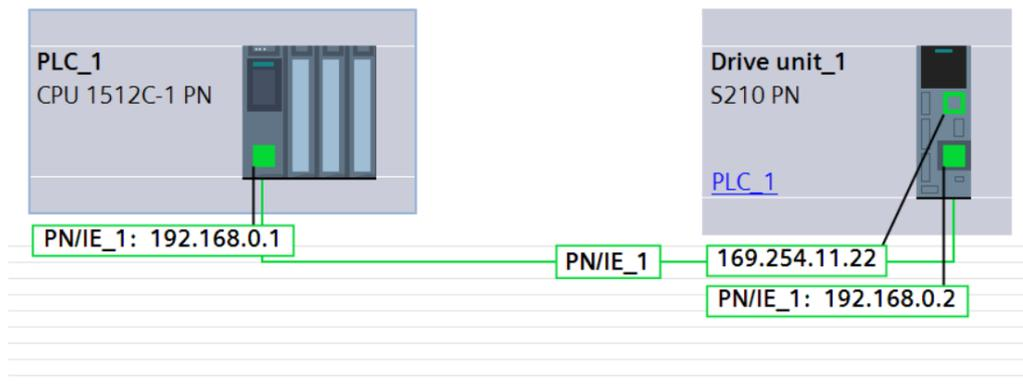
Figura 45: Collegamento di rete tra Drive e PLC
