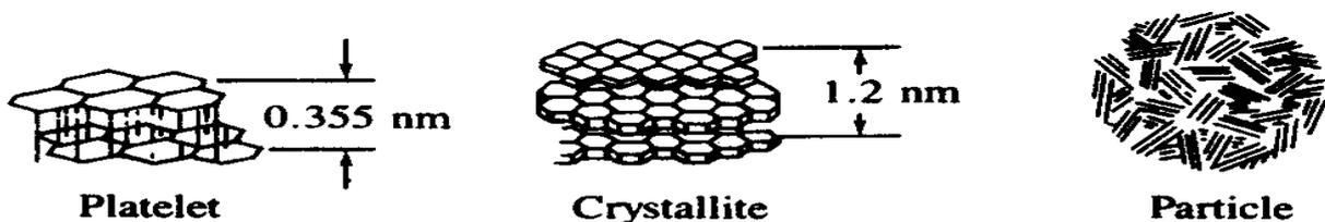
Figura 1.19 Evoluzione della struttura delle particelle carboniose di particolato [2]
