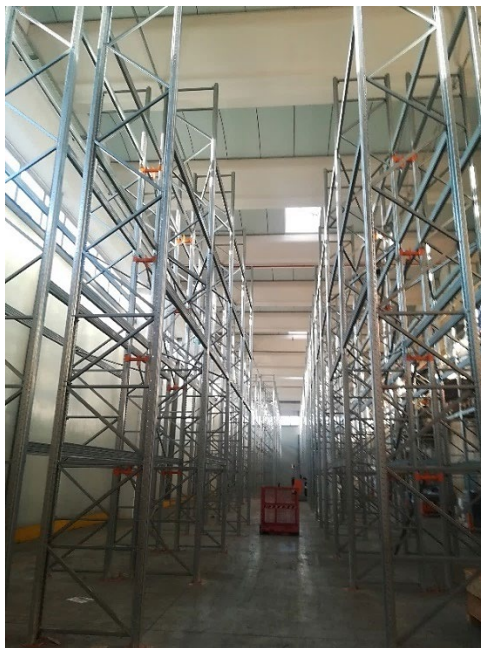
Figura 4.9: Scaffalature tradizionali bifronte. Fonte: foto scattata in azienda
