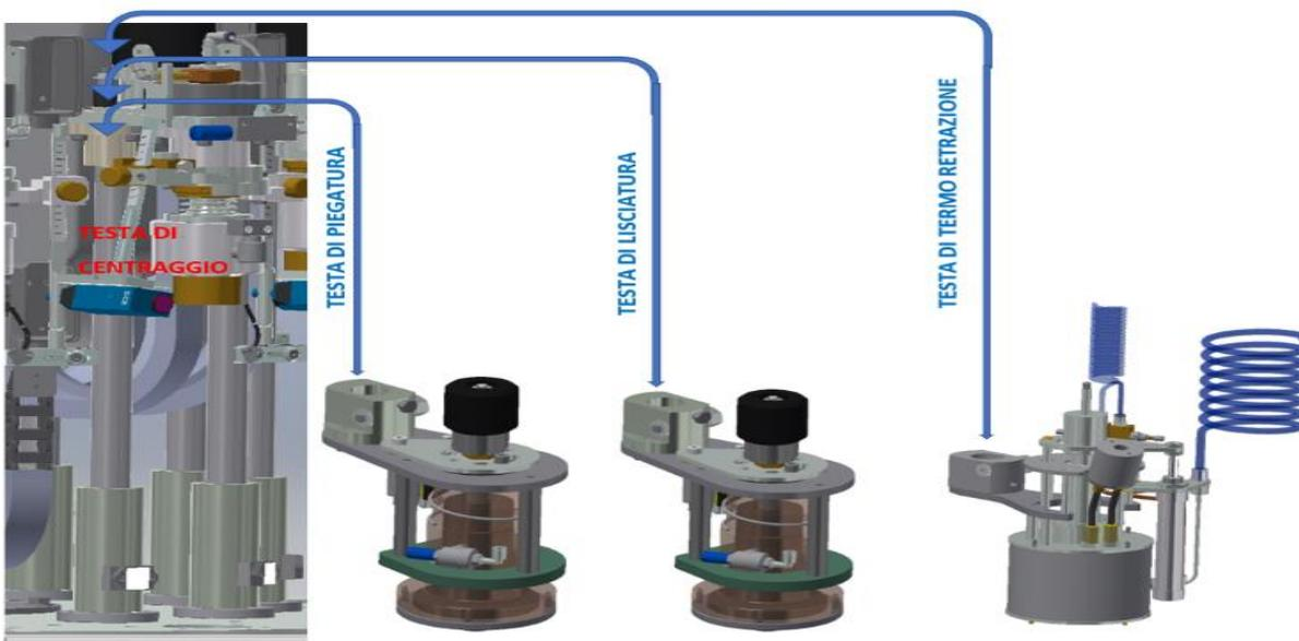
**Figura 6.1.1: teste per le diverse fasi di capsulatura**
