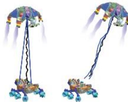
Figura 2.14: Visualizzazione dello "sky crane" e fase di allontanamento del DS [19]
