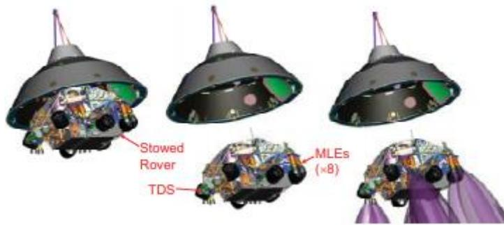
Figura 2.13: Separazione del "Backshell" e sequenza di caduta libera [19]
