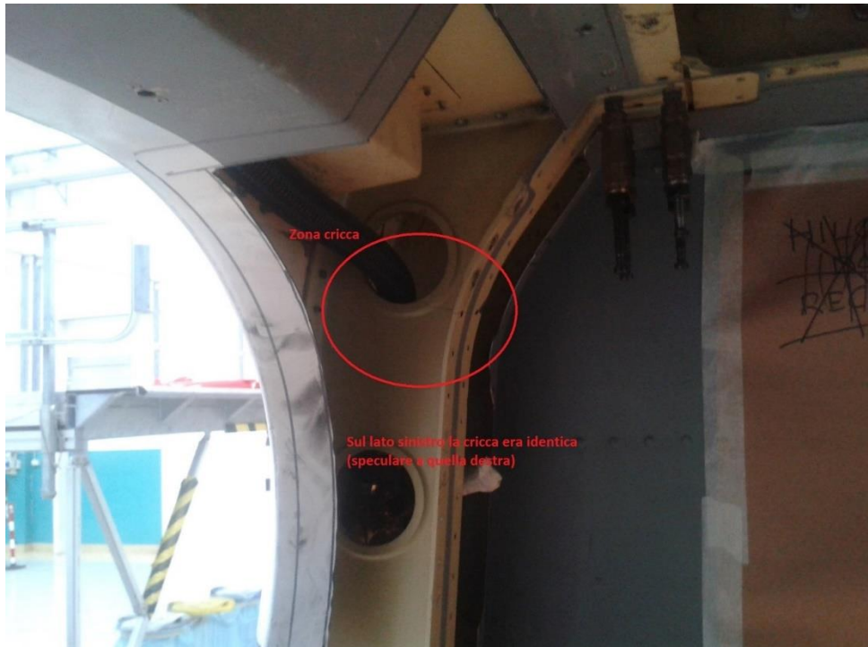
Figura 33: Collocazione della cricca sul lato destro dell'ordinata STA5700
