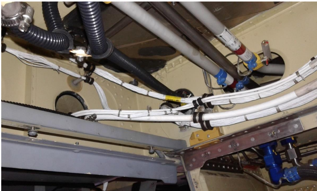
Figura 27: Fori di alleggerimento all'interno della cabina di un AW139
