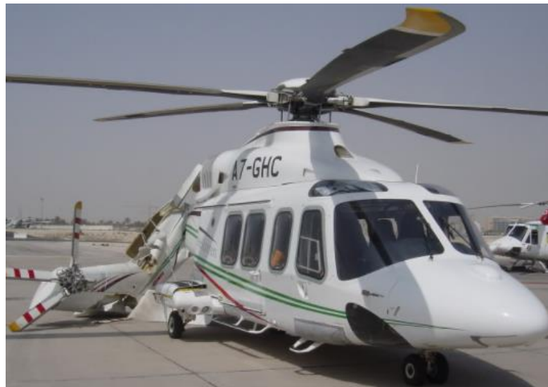
Figura 9: Distacco della coda sull'AW139 A7-GHC [7]
