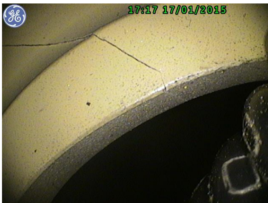
Figura 38: Dettaglio cricca sul versante sinistro dell'ordinata
