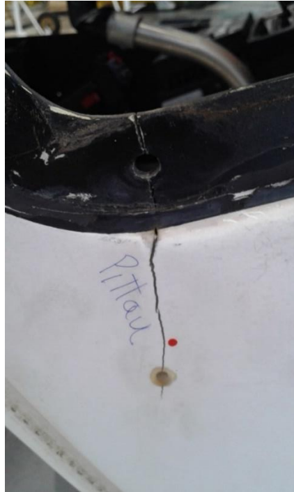
Figura 11: Cricca sul case dell'elicottero R22
