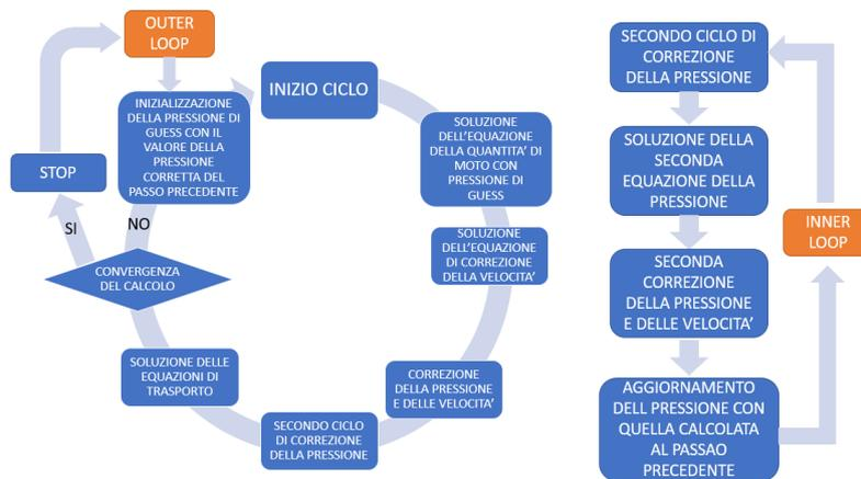
Figure 3.4: Schema algoritmo PIMPLE
