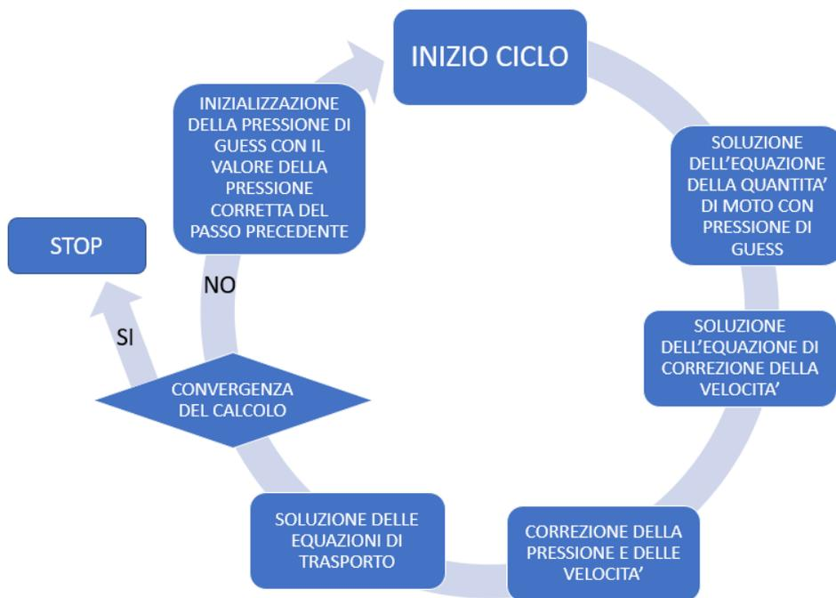
Figure 3.2: Schema algoritmo SIMPLE [9]
