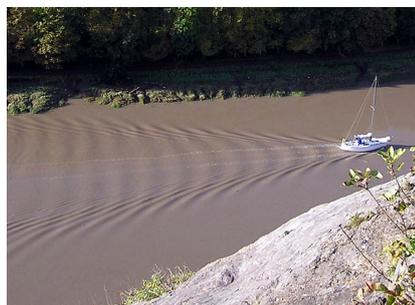
Figure 2.5: Sistema di onde generato dalla barca [3]
