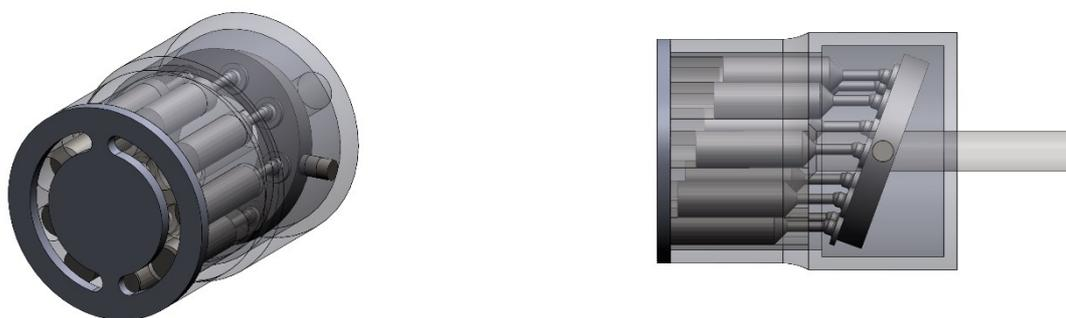
*Figura 2.7 Vista in prospettiva (sinistra) e laterale (destra) del modello CAD approssimativo di una pompa assiale*
