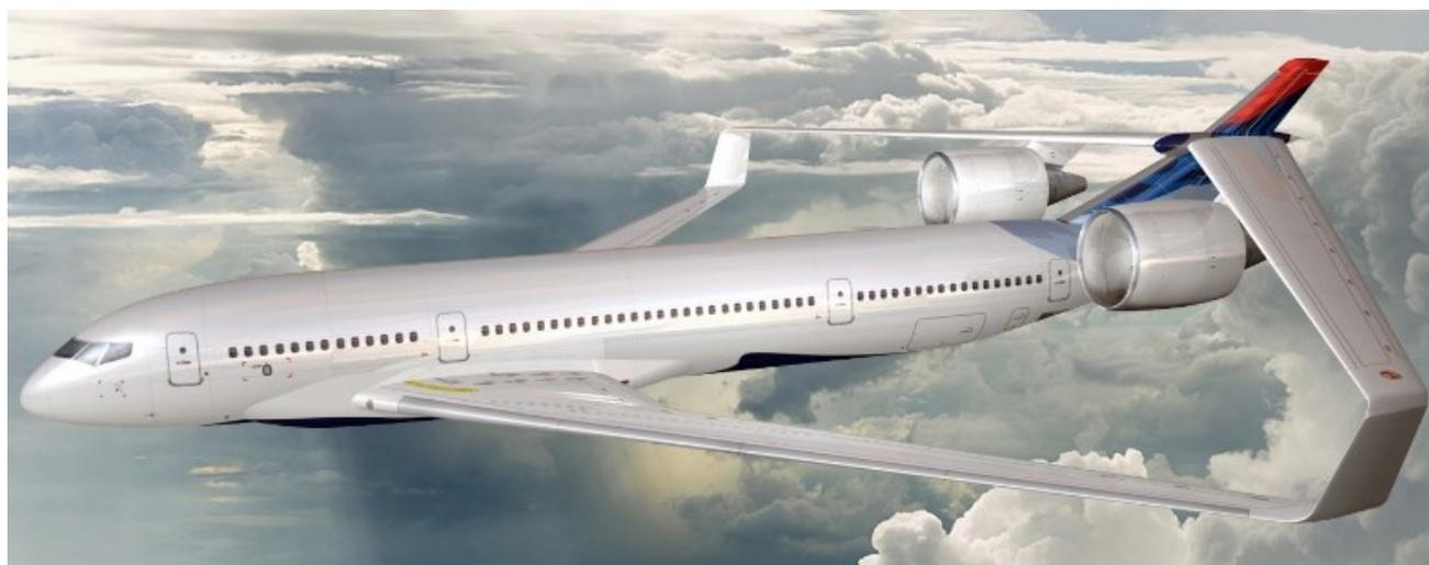
Figura 1.6 Aeromobile con ala a scatola e a freccia (concept Lockheed)
