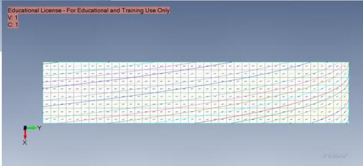
Figura 94, Mesh piastra cantilever con orientamento del materiale in relazione alla curva di riferimento secondo la direzione x
