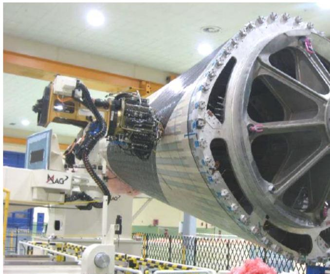
*Figura 7, Laminazione AFP sezione di fusoliera Boeing 787, Leonardo Grottaglie [1]*
