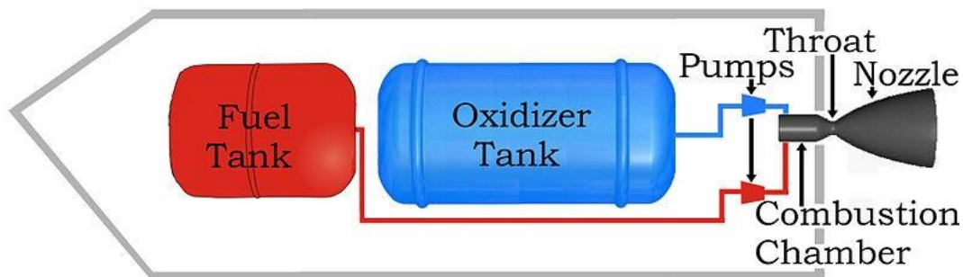
Figura 3.3 Impianto propulsivo di un razzo a propulsione chimica
