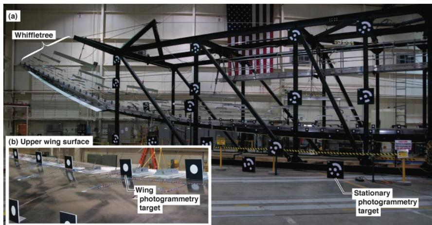
**Figura 1.3 - Ala sinistra del Global Observer durante i test di carico [10]**
