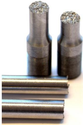
Figura 22: Rottura fragile, [21]
