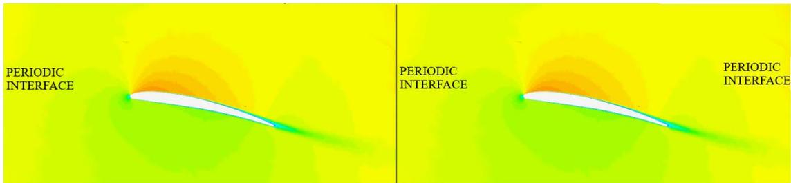
Figura 6-3: principio dell'interfaccia periodica
