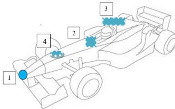
Figure 5: Sensors placement: 1) LIDAR, 2) IMU, 3) Stereo Camera, 4) RTK GNSS module
