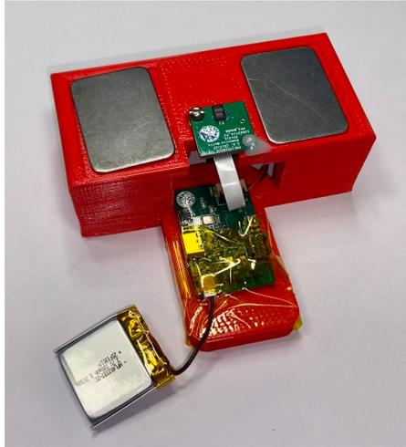
**Figura 3.4:** Dispositivo PulseEcg
