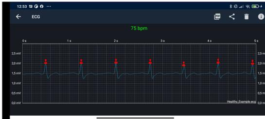
**Figura 7.6:** Esempio di rilevamento picchi con un segnale normale
