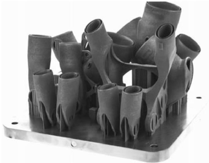
*Figura 1.7 Telaio di una bicicletta da corsa prodotto con AM. Fonte: articolo [26]*
