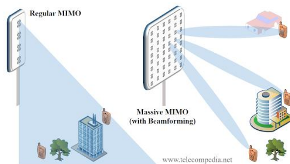
Figura 3 – Confronto tra Regular MIMO e Massive MIMO con tecnologia Beamforming Fonte: Telecompedia
