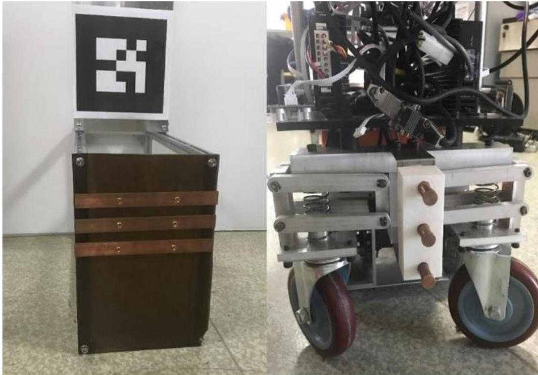
FIGURA 8 STAZIONE DI RICARICA IDENTIFICATA DAL TAG E ROBOT CON CILINDRI ADIBITI ALLA RICARICA (GENG, 2017)
