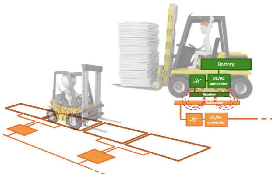
Figura 10- Sistema di ricarica wireless di Enermove
