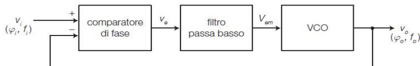
Figura 4.10. Schema a blocchi PLL
