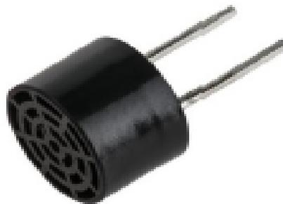
Figura 1.3. Trasduttore a basso costo per applicazioni in atmosfera
