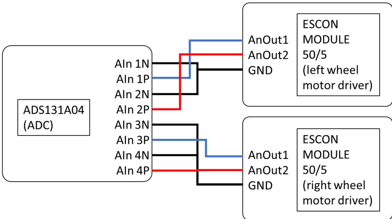
Figure 5.4 Escon Module 50/5 -> ADS131A04 Connections
