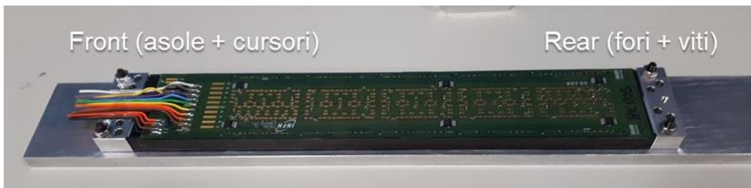
Figura 5. 1: Base che simula il sistema di cursori implementato sul frame
