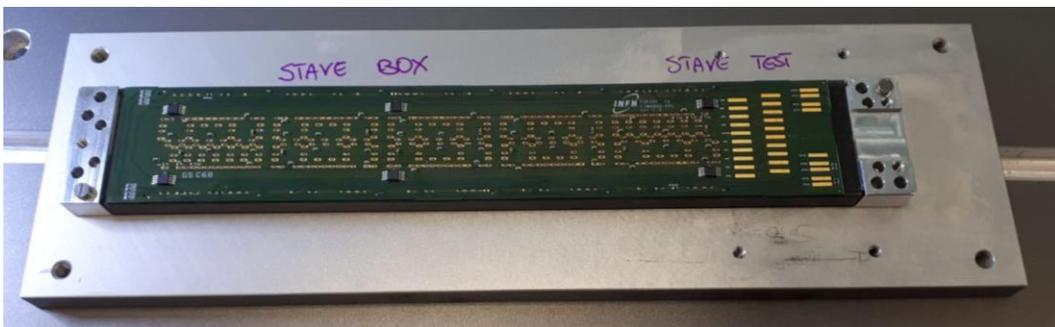
Figura 3. 25: Stave posizionato sulla base metallica del Box di storage
