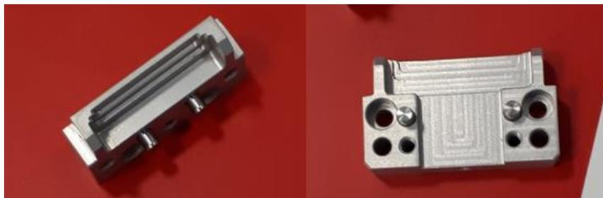
Figura 3. 15: Incollaggio delle spine in titanio nel blocchetto terminale
