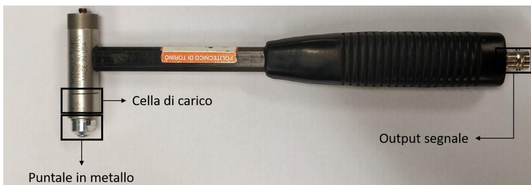
Figura 3.6: Martello strumentato
