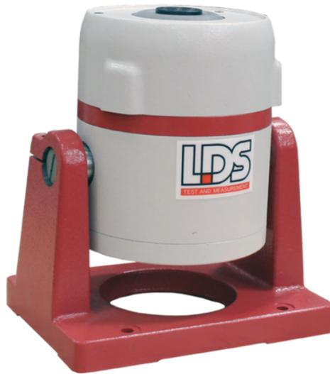
Figura 3.23: Shaker elettrodinamico
