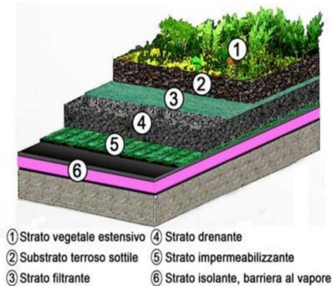
Figura 75 Esempio di schema dei vari strati che compongono un tetto verde(fonte: Nextville.it)
