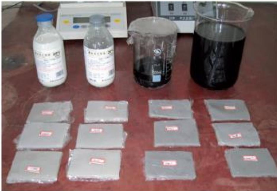
**Figura 3.2** Materiali utilizzati e fantocci con diverse proprietà ottiche in base alla concentrazione di materiali utilizzati.[34]
