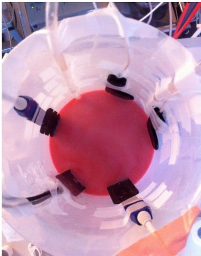
**Figura 3.9** Vista dall'alto del fantoccio liquido all'interno del contenitore e delle sonde utilizzate per le misurazioni.[24]
