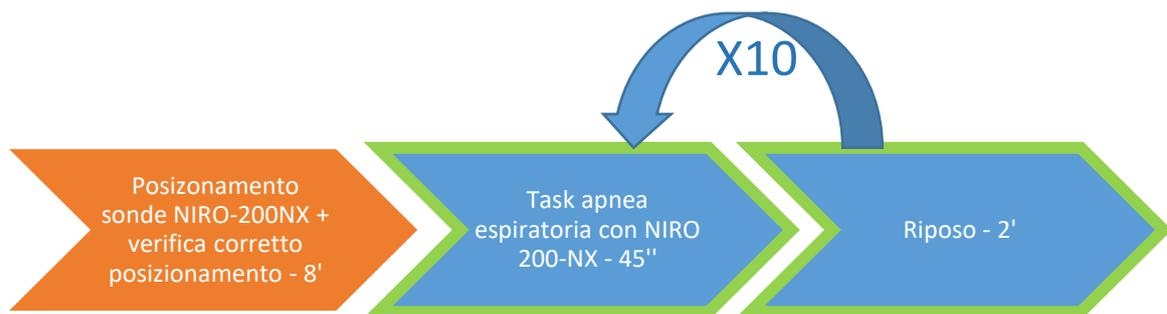
**Figura 2.3** Schema del ciclo di registrazione. Il posizionamento delle sonde dello strumento NIRO-200NX e la verifica del corretto funzionamento ha una durata di circa 8' a seconda del soggetto (in arancione). Successivamente segue l'esecuzione del task di apnea espiratoria seguito da una fase di riposo che varia da soggetto a soggetto. In media sono necessari 2' dopo l'esecuzione del task. Questi ultimi due blocchi sono ripetuti 10 volte.
