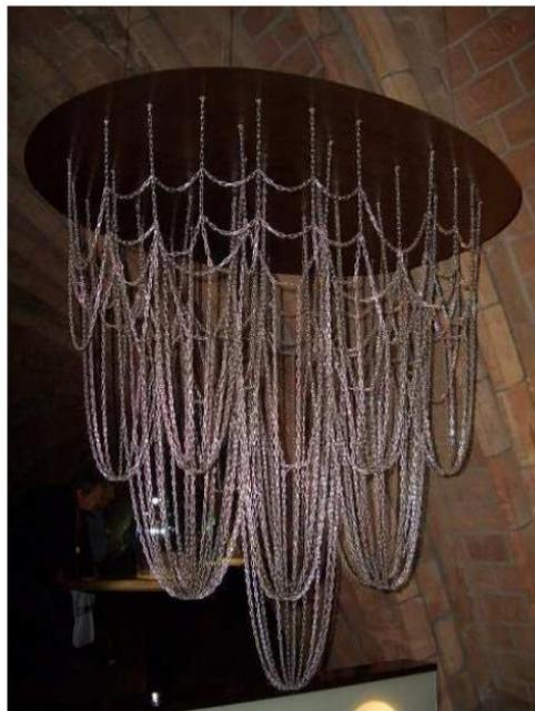
*Figura 15 – Modello parametrico a catena sospesa*
