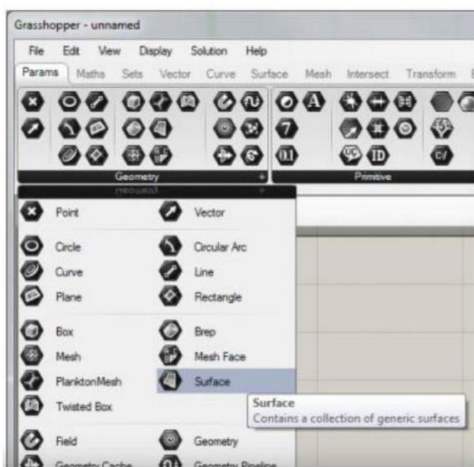
Figura 28 - Componenti geometriche di Grasshopper
