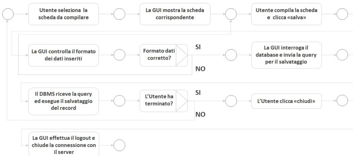
Figura 2.7: Workflow diagram relativo al processo *Compilazione scheda*
