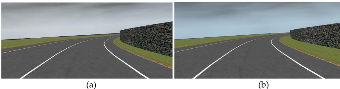
Fig. 14 Rappresentazione delle condizioni di visibilità in curva destrorsa: (a)  $R=225\text{ m}$ ,  $d = 1.5\text{ m}$ , (b)  $R=225\text{ m}$ ,  $d = 3\text{ m}$
