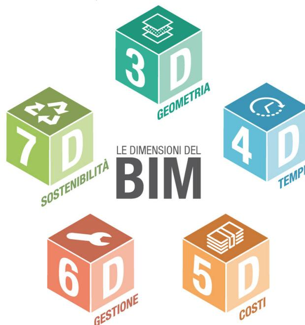
Figura 1 5: La multidimensionalità del BIM
