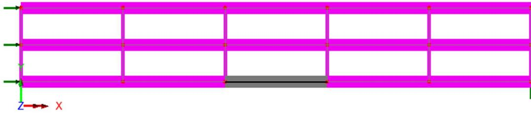
Figure 8.3: modello con porzione di trave di rigidezza inferiore
