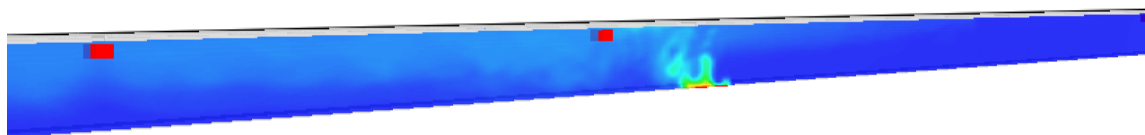
Figura 4.43 Temperatura dei gas sul piano XZ a 360 secondi.
