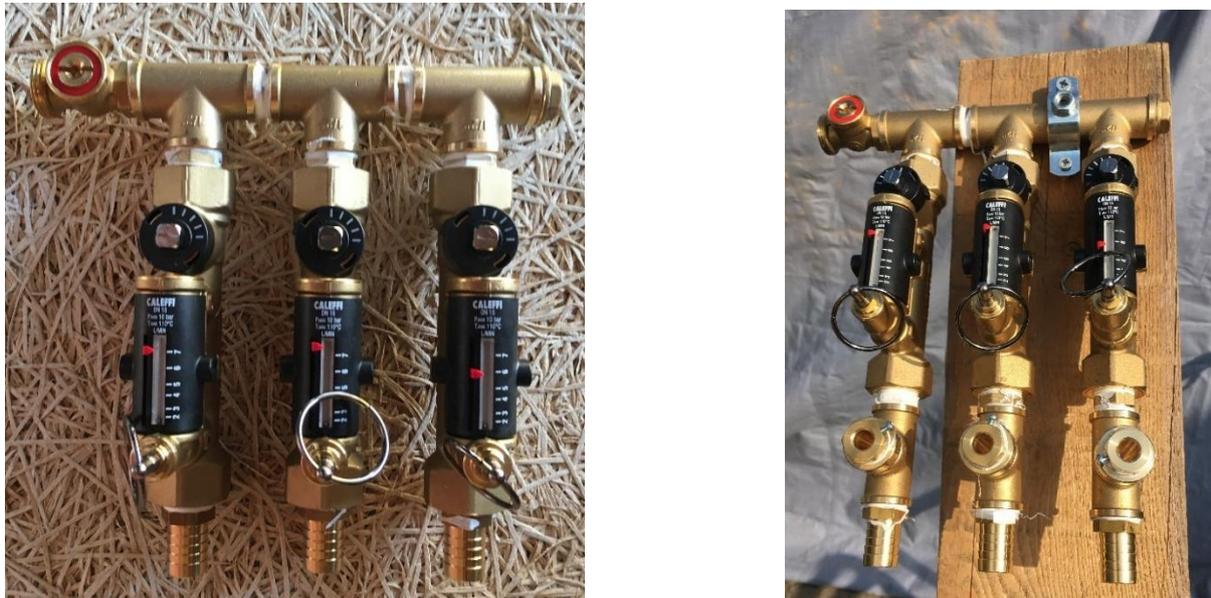
Figura 62: A sinistra flussometri Caleffi in ottone con valvola di bilanciamento e lettura diretta della portata; a destra flussometri con pozzetti per il rilevamento della temperatura.
