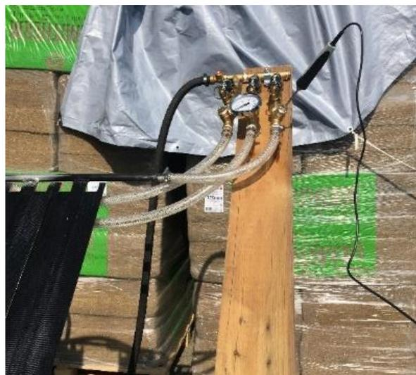
*Figura 67: Fase di rilevamento della temperatura in uno dei pozzetti dei tre sistemi di strip.*
