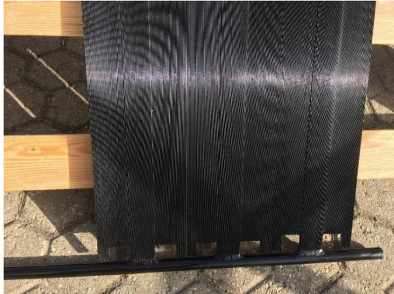
Figura 61: Assorbitore composto da strip Ecobel con trattamento meccanico superficiale e verniciatura spray Solkote.
