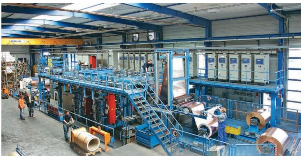
Figura 48: Produzione trattamento selettivo su strip solari – Alanod [36].
