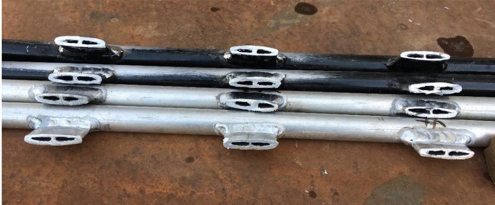
*Figura 68: Taglio delle strip per verificare che la saldatura non ostruisce il passaggio di fluido.*
