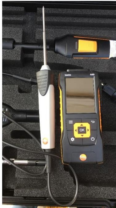
*Figura 66: Sonda di rilevazione della temperatura ad immersione di marca Testo e rispettivo strumento di lettura.*
