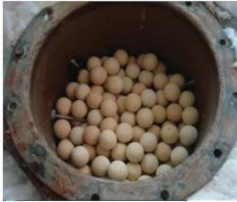
Figura 5.20 Accumulo termico a letto impaccato con particelle ceramiche [22]
