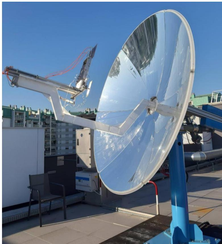
Figura 4.1 Concentratore solare parabolico installato sul tetto dell'Energy Center
