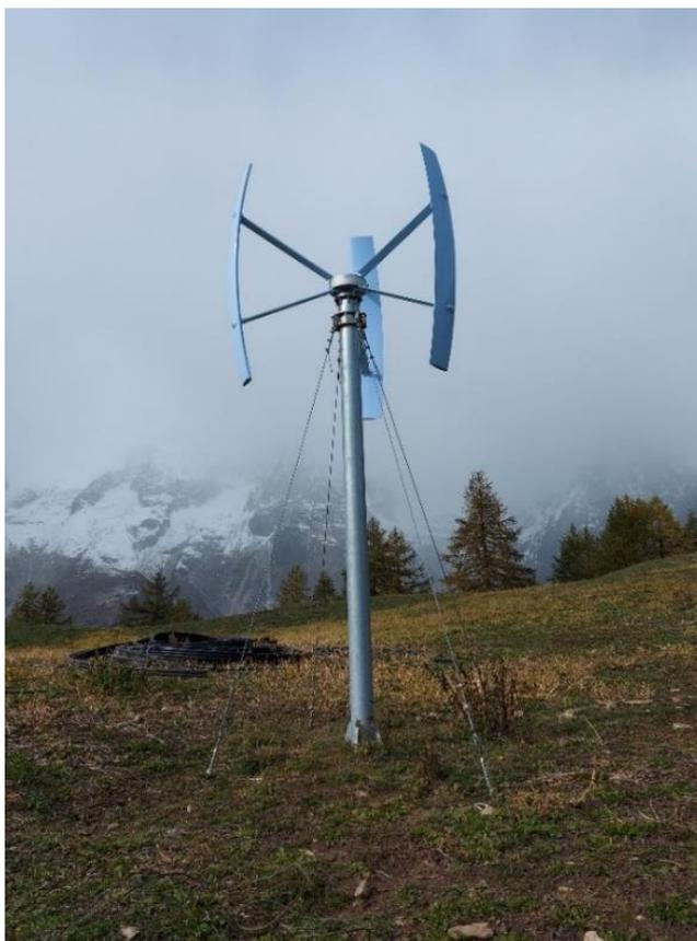
Figura 81 - Turbina eolica ad asse verticale
