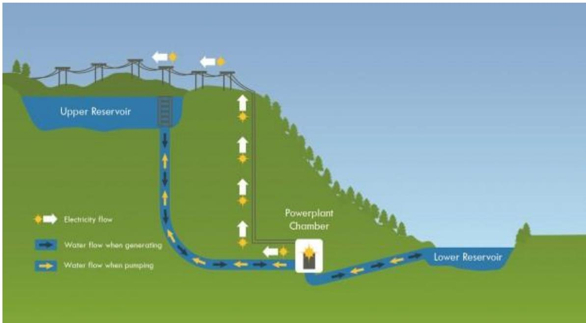
Figura 38 – Schema funzionamento pompaggio in un impianto idroelettrico [52]
