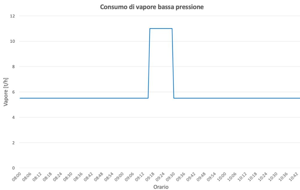
Figura 47. Effetto dell'accumulatore di vapore
