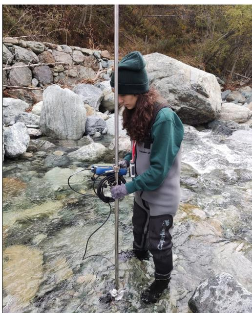
*Figura 7 – Misura della velocità attraverso il correntometro elettromagnetico, foto scattata durante il rilievo idro-morfologico presso il torrente Chalamy, Valle d'Aosta, Italia.*
