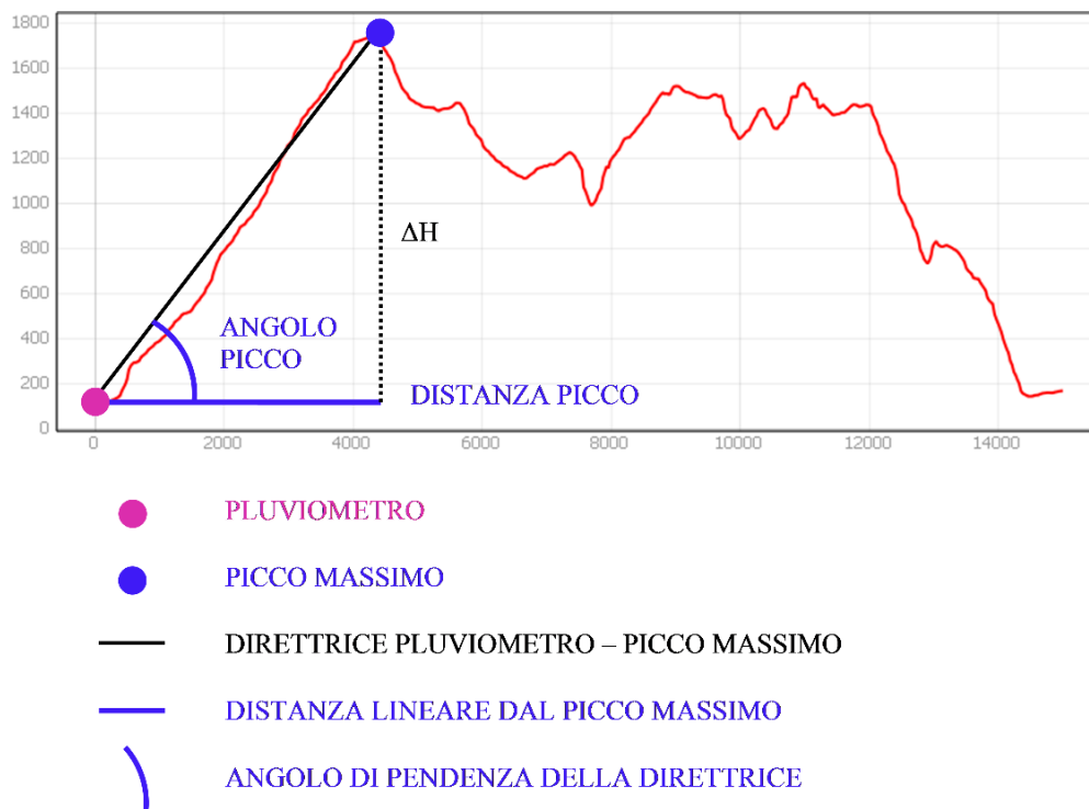
Figura 25. Parametri Angolo picco e Distanza picco, rappresentati per il Pluviometro 21311 "Malcesine".
