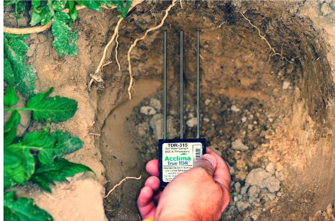
Figura 2.1 – Esempio di sensore di umidità del suolo che sfrutta la tecnologia Time-Domain Reflectometry (Fonte: Landscape Technologies).
