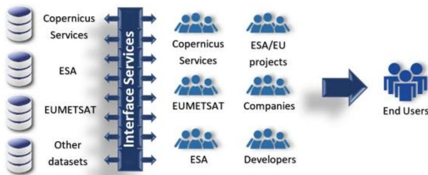
Figura 3.3 – Schema di accesso ai dati grezzi acquisiti da diversi satelliti. I DIAS sono rappresentati dagli Interface Services e consentono ad aziende, sviluppatori e istituzioni di accedere alle informazioni contenute in vari dataset e di realizzare degli specifici prodotti che sono resi accessibili al pubblico finale (aziende e cittadini privati) (Fonte: Copernicus DIAS).
