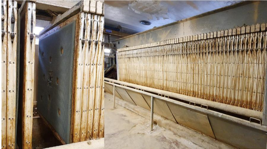
Figura 29-Particolare piastra - Filtropressa
