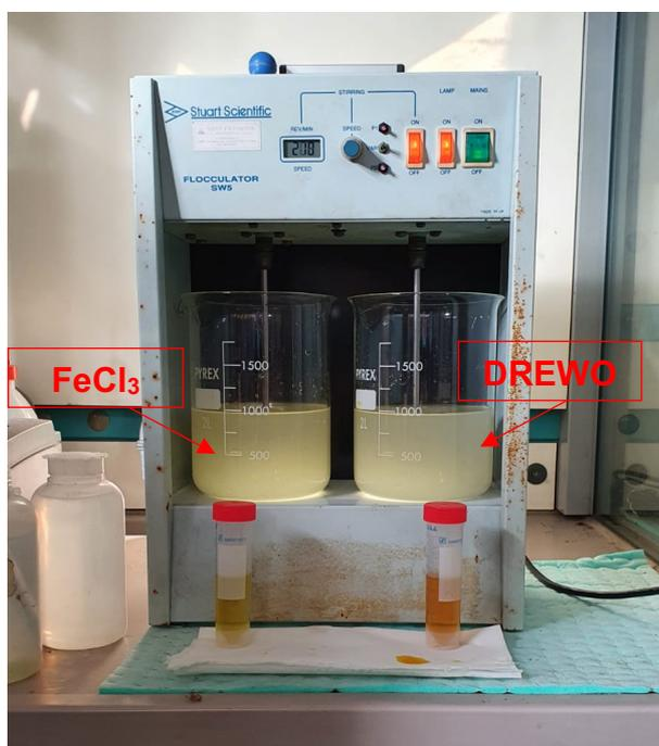
Figura 31-Jar Test con additivi
