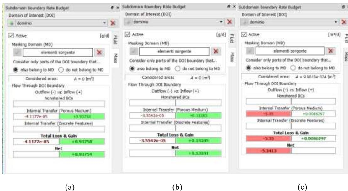
**Figura 66-** Bilancio di massa ottenuto dallo strumento di FEFLOW Subdomain Rate Budget per simulazione di contenimento fisico (a) e contenimento fisico con inversione di piezometria (b)
